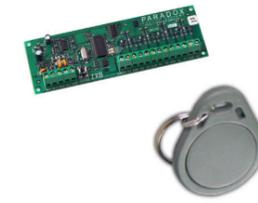
**PROX-Modul zum zentralen Einbau, Proximity CHIP-Schlüsselanhänger**
